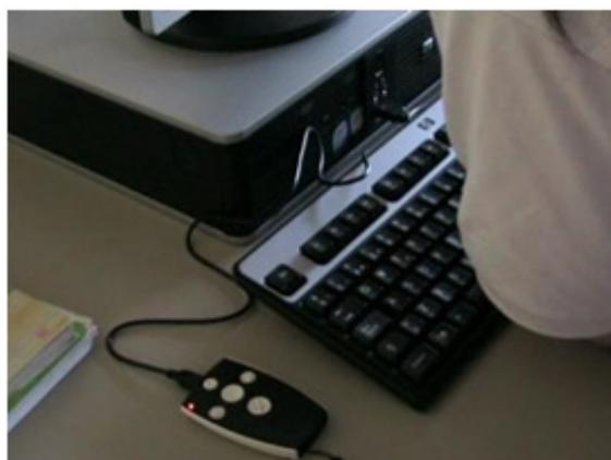
El móvil se conectó al ordenador utilizando el cable proporcionado por el fabricante del móvil para su conexión a un puerto USB del ordenador. Una vez conectado, mediante el programa de gestión del móvil —proporcionado, también, por el fabricante— se copiaron los ficheros desde el ordenador en una carpeta del mismo.
