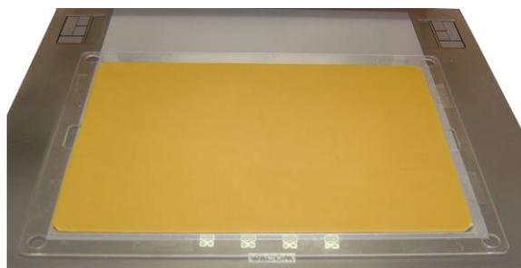
Figura 3: Lámina de caucho situada sobre la tableta digitalizadora.
