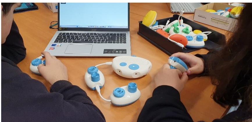
Ilustración 4 Code Jumper. Programación manipulativa y en ordenador. Accesible con revisor de pantalla.
